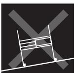
**UNIT SHALL ONLY BE USED ON FIRM AND LEVEL SURFACES**
